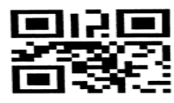
شكل رقم (3) يوضح شكل الإصدار 1 مقاس 21X21 الكمية 25-10 رمز حرف رقمي
