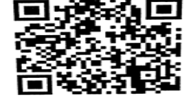
شكل رقم (6) يوضح شكل الإصدار 4 مقاس 33X33 الكمية 114-50 رمز حرف رقمي
