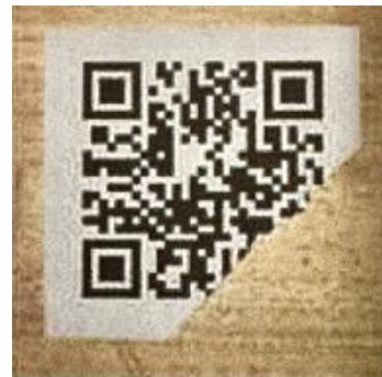
الشكل رقم (9) الكود تالف ورغم ذلك يعمل ويفتح الرابط التالي
