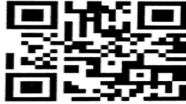
شكل رقم (4) يوضح شكل الإصدار 2 مقاس 25X25 الكمية 47-20 رمز حرف رقمي
